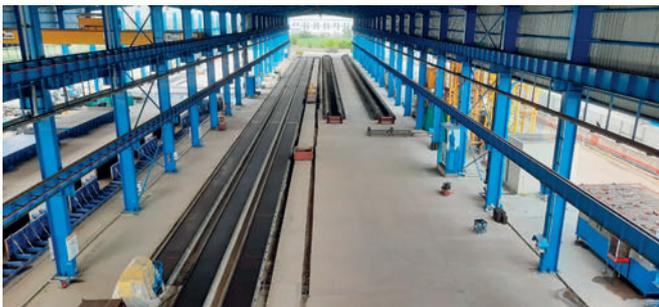
Au total, quatre bancs d'une longueur de 145 mètres produisent des éléments préfabriqués en béton précontraint dans la nouvelle usine de Stellar Precast.
