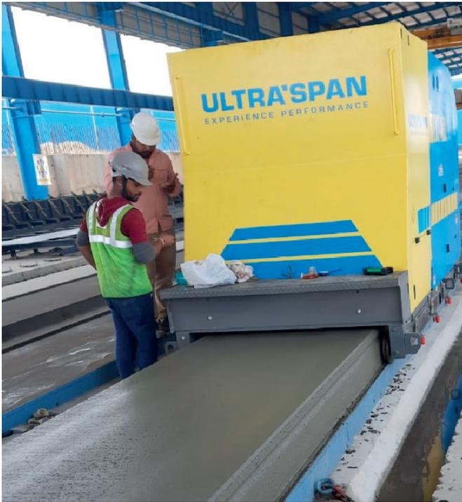
L'extrudeuse d'UltraSpan assure une production rapide et de haute qualité de dalles alvéolées sur des bancs de précontrainte.
