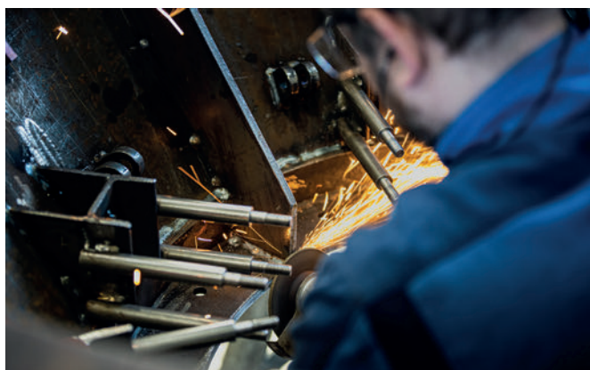
Noyau de moule Tornado pour cône de réduction en cours de traitement
