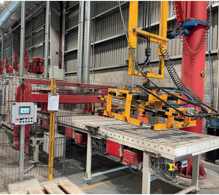
Alimentation par grue pivotante et pince 4 côtés, convoyeur à rouleaux intégré dans le système de sécurité
