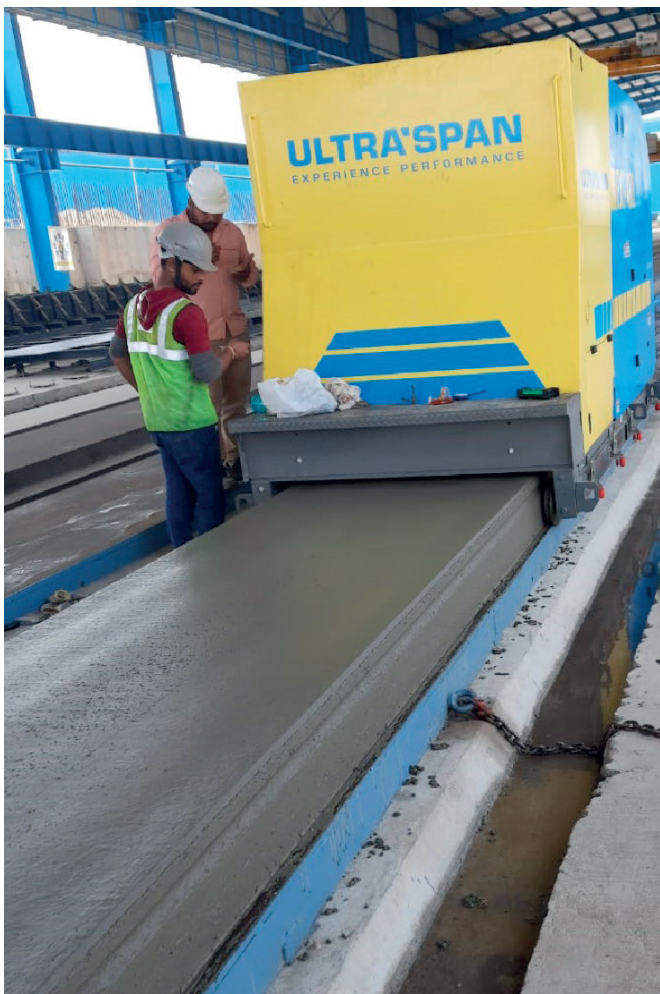
La extrusora de UltraSpan permite una producción rápida y de alta calidad de placas alveolares en bancos de pretensado.
