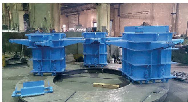
Camisas de molde Variant para fabricar marcos de hormigón rectangulares
