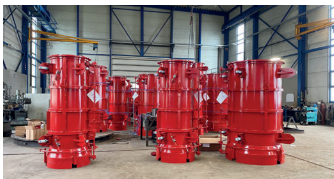
Diversas camisas de molde de prensa radial para fabricar tubos de hormigón
