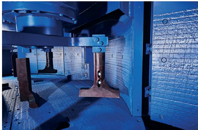
*Durchdachtes Innenleben: Robuste Mischwerkzeuge und Seitenabstreifer, die modulare Bauweise sowie große Zugangsöffnungen sind auf den ersten Blick erkennbare, unverwechselbare Produktmerkmale der PH-Serie.*
