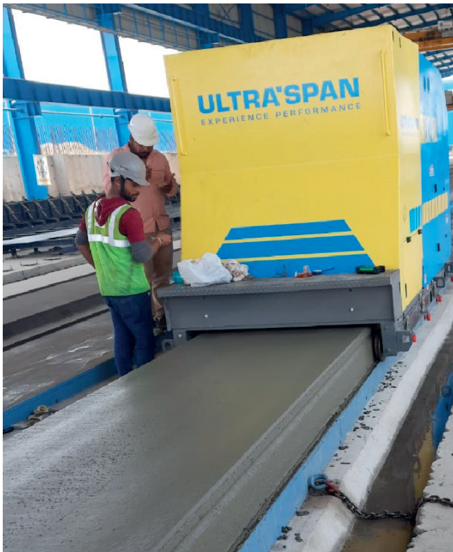
Der Extruder von UltraSpan sorgt für eine schnelle und qualitativ hochwertige Produktion von Spannbetonfertigdecken auf Spannbetten.
