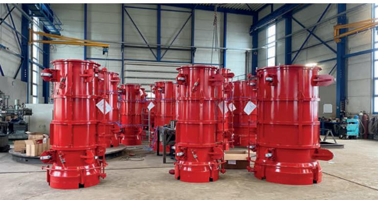
Diverse Radialpressen-Formmäntel zur Herstellung von Betonrohren
