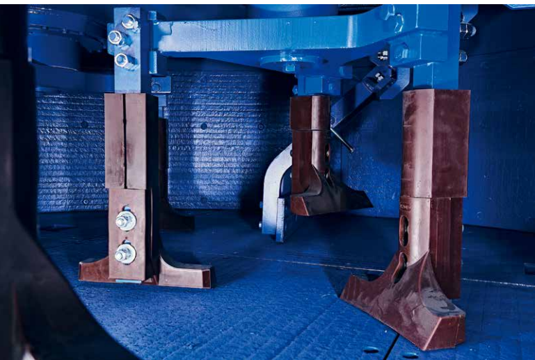
复杂的内部运作：稳固的搅拌工具和侧刮板，模块化设计，以及大检修口无疑是 PH 系列搅拌机一目了然的产品特点
