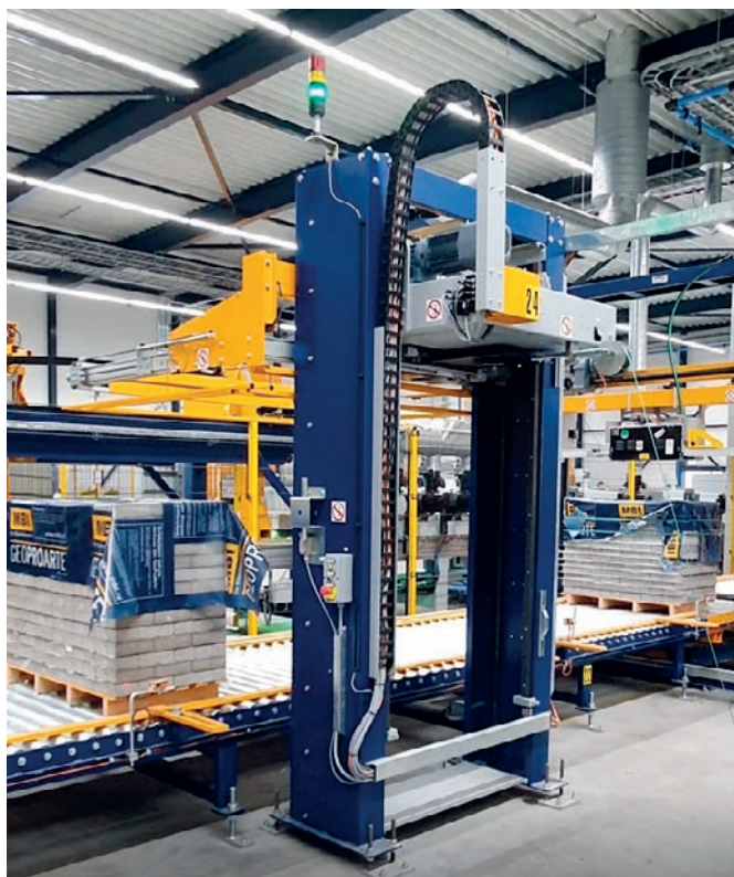
Pakiet owinięty poziomo i pionowo z folią górną i między warstwami wyrobów.
