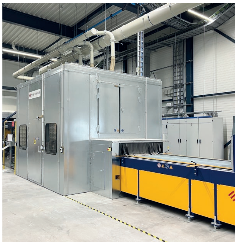
Komora dźwiękochłonna z maszyną do postarzania wyrobów.
