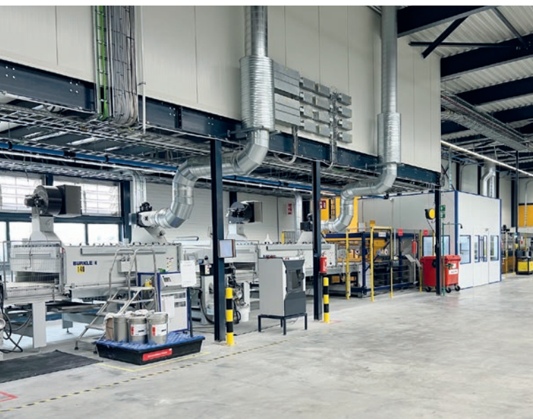
Drukarka indywidualnie zadrukowuje wyroby żądanym motywem przy prędkości posuwu 8 m/min.
