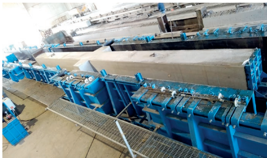
Produkowane słupy ze wspornikami mają długość 28,5 m.
