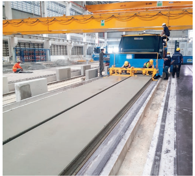
Slipformer S-Liner to elastyczna maszyna. Może produkować jednocześnie jedną płytę o szerokości 1,2 m i dwie płyty o szerokości 0,6 m lub dwie płyty o szerokości 1,2 m.
