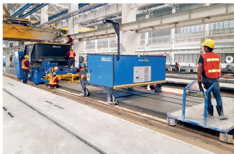
Automatyczny ploter SmartJet pracuje z danymi CAD, które są importowane do oprogramowania Ebos HC. Dzięki temu urządzeniu znakowanie na płytach przebiega szybko i nie dochodzi do pomyłek. Oznaczenia do wykrywania linii są wykonywane w tym samym czasie.
