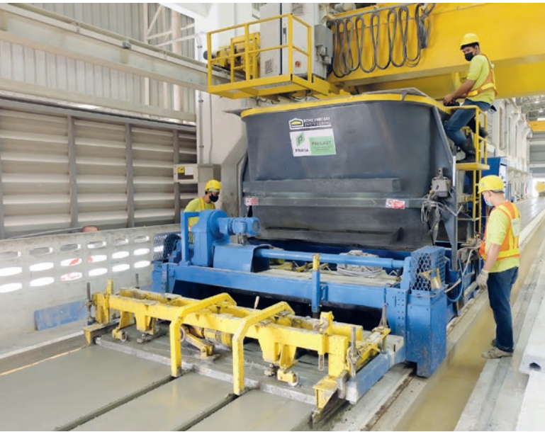
Slipformer S-Liner to elastyczna maszyna. Może produkować jednocześnie jedną płytę o szerokości 1,2 m i dwie płyty o szerokości 0,6 m lub dwie płyty o szerokości 1,2 m.
