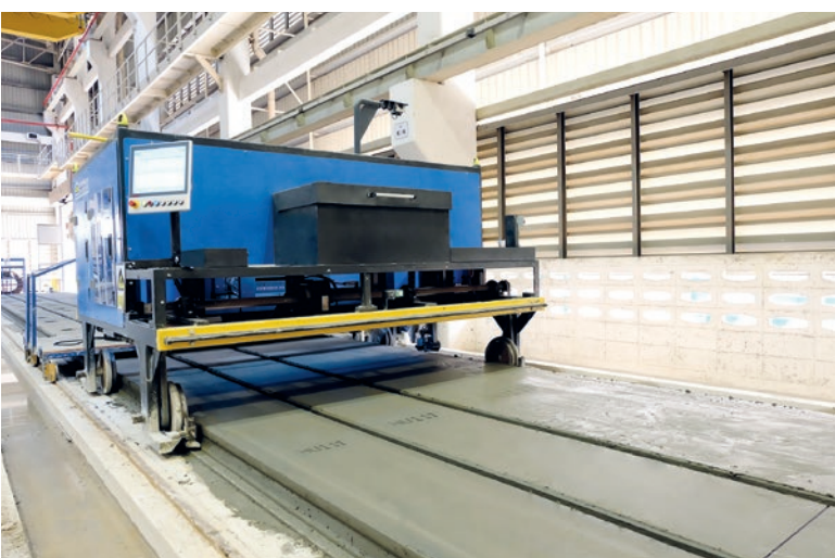
Automatyczny ploter SmartJet pracuje z danymi CAD, które są importowane do oprogramowania Ebos HC. Dzięki temu urządzeniu znakowanie na płytach przebiega szybko i nie dochodzi do pomyłek. Oznaczenia do wykrywania linii są wykonywane w tym samym czasie.
