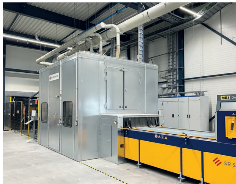
Camera insonorizzata per l'impianto di invecchiamento
