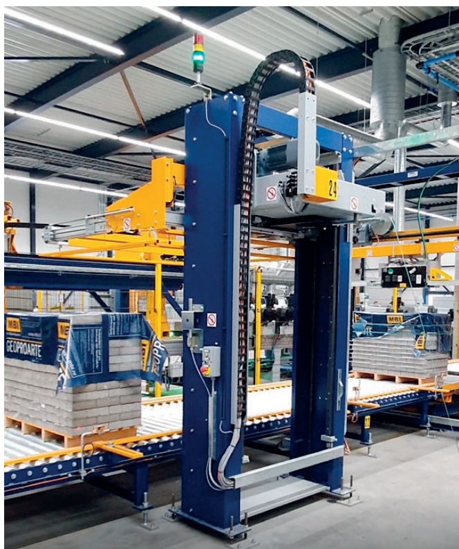
Imballo reggiato orizzontalmente e verticalmente con pellicola intermedia e superiore
