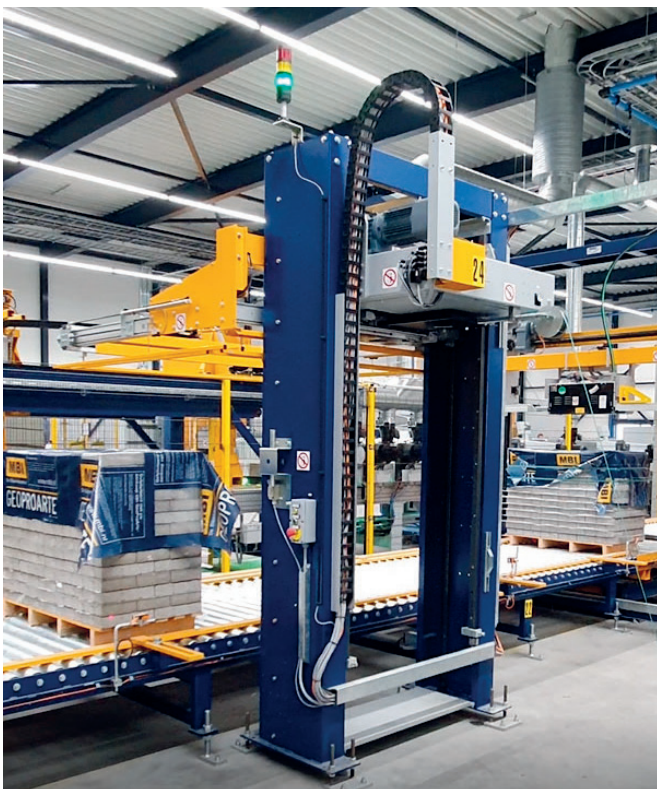
Paquet cerclé horizontalement et verticalement avec film intermédiaire et film supérieur
