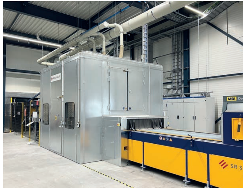
Chambre à isolation phonique pour l'installation de vieillissement
