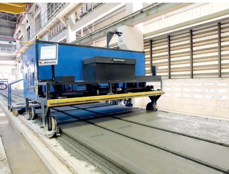
Le traceur automatique SmartJet utilise les données CAO importées dans le logiciel Ebos HC. Il assure un marquage rapide et sans erreur des éléments.
