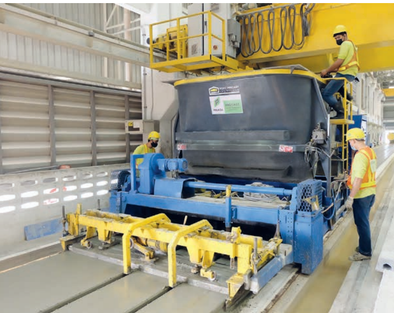
Le Slipformer S-Liner est une unité de coffrage flexible, capable de produire simultanément 1 prédalle de 1,2 m et 2 de 0,6 m, ou 2 prédalles de 1,2 m.
