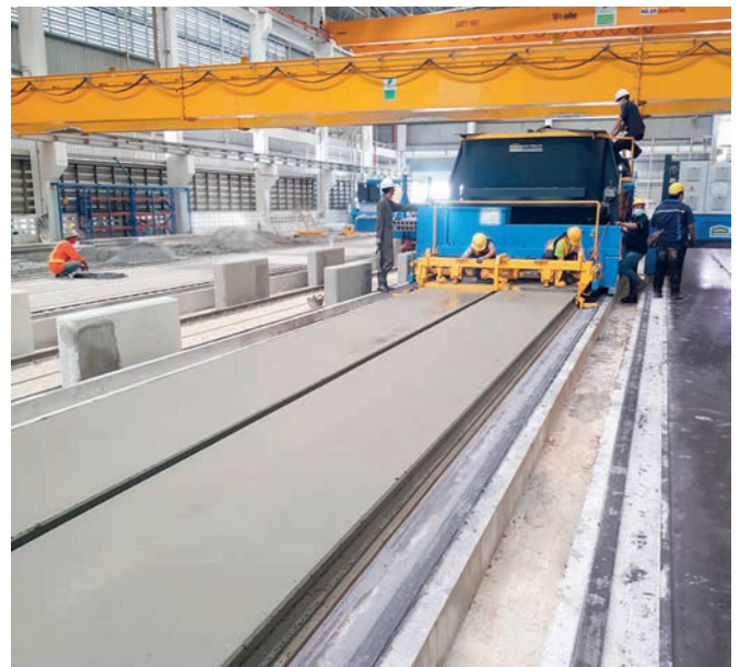
Le Slipformer S-Liner est une unité de coffrage flexible, capable de produire simultanément 1 prédalle de 1,2 m et 2 de 0,6 m, ou 2 prédalles de 1,2 m.
