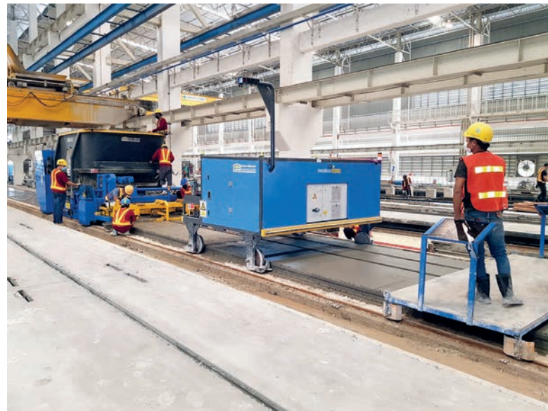
Le traceur automatique SmartJet utilise les données CAO importées dans le logiciel Ebos HC. Il assure un marquage rapide et sans erreur des éléments.
