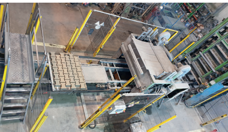
Nuevos equipos de seguridad en el lado húmedo de la producción
