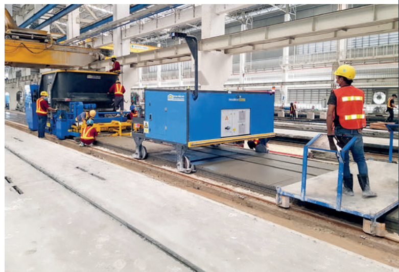
El plóter automático SmartJet procesa datos CAD que se importan al software Ebos-HC. La máquina garantiza una colocación rápida y sin errores de las marcas en los elementos
