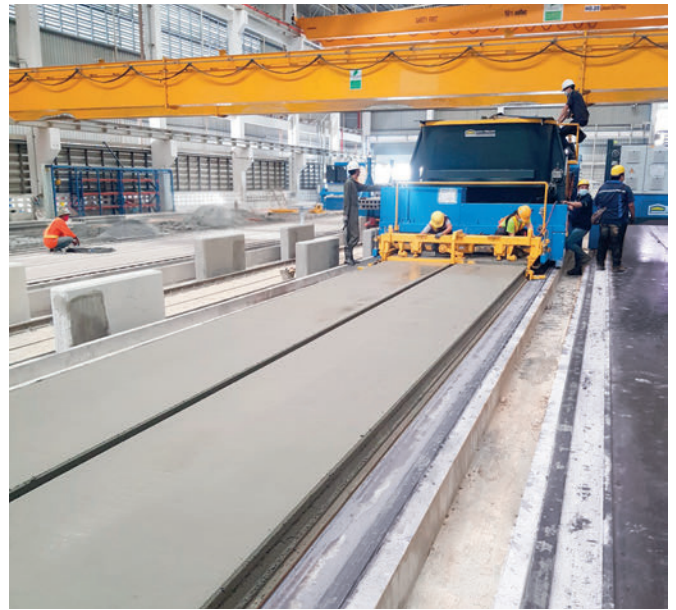
La máquina deslizante S-Liner es una máquina flexible para la producción simultánea de un elemento de 1,2 m y dos elementos de 0,6 m o de dos elementos de 1,2 m de ancho
