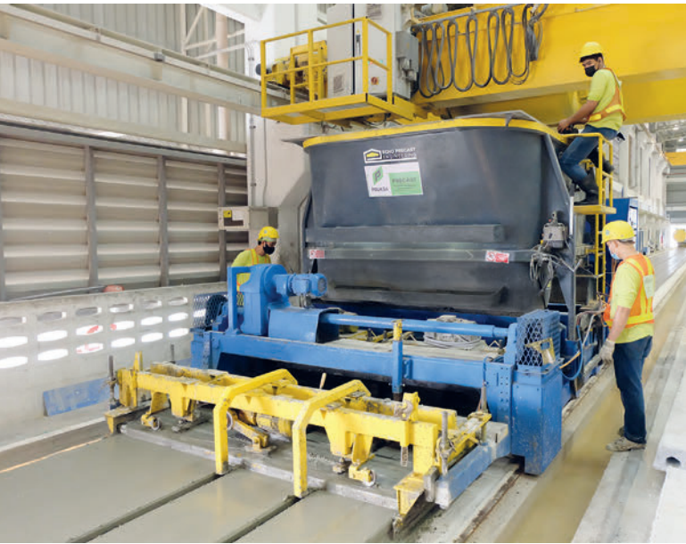
La máquina deslizante S-Liner es una máquina flexible para la producción simultánea de un elemento de 1,2 m y dos elementos de 0,6 m o de dos elementos de 1,2 m de ancho
