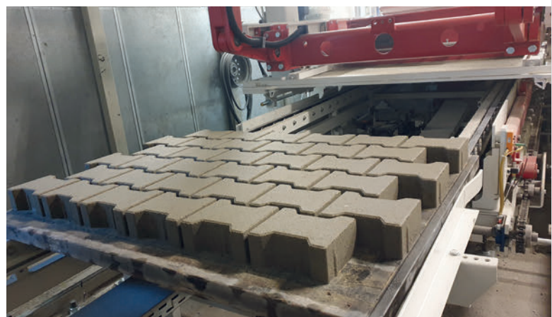
Start der Produktion mit der Betonsteinmaschine RH 2000-4 MVA
