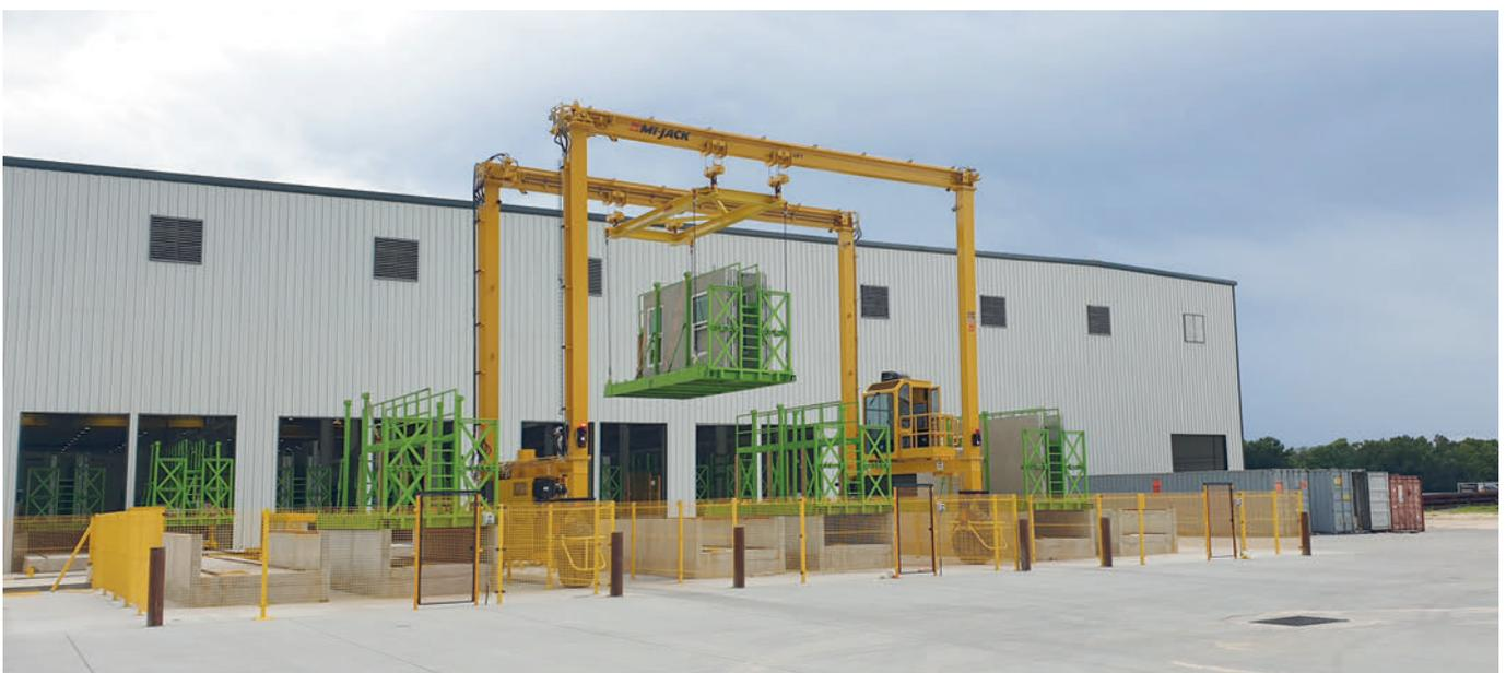
Das Handling im Außenbereich erfolgt durch einen mobilen Portalkran, der die Wandtransportgestelle ein- und auslagert.
