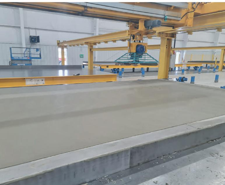
Drei Palettenlinien stehen zum Glätten der Betonoberfläche zur Verfügung.
