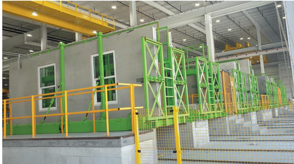
Über ein automatisches Ausfahrssystem werden die fertigen Wände auf kommissionierten Wandtransportgestellen aus der Halle transportiert.
