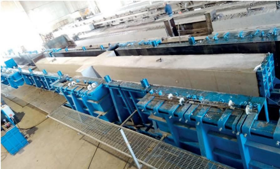
Die produzierten Stützen mit Konsolen sind 28,5 m lang.
