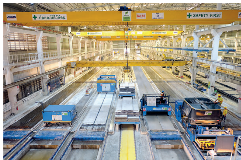
Die beiden Werke wurden mit neuen Maschinen für die Produktion von Spannbetonfertigdecken ausgestattet.
