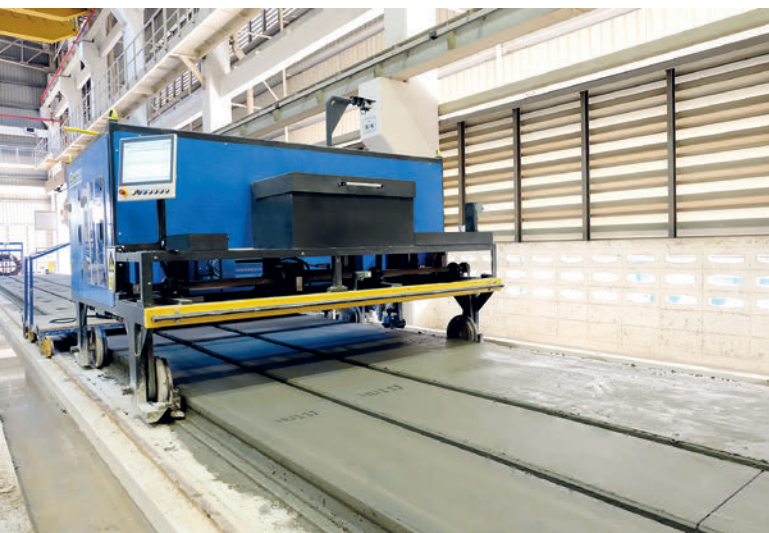
Der automatische SmartJet-Plotter verarbeitet CAD-Daten, die in die Ebos-HC-Software importiert werden. Die Maschine gewährleistet ein schnelles und fehlerfreies Aufbringen von Markierungen auf den Elementen.
