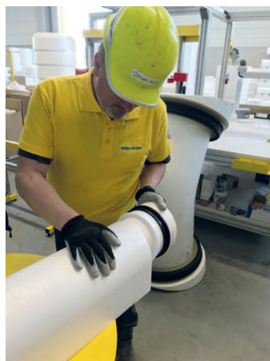
Die Herstellung kompletter Gerinne erfolgt durch einfache Zuschnitte und Verklebungen.
