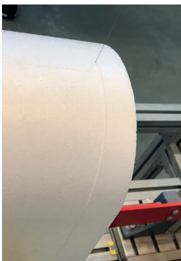
Die Herstellung kompletter Gerinne erfolgt durch einfache Zuschnitte und Verklebungen.
