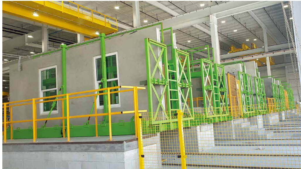
借助自动化运输系统，完工的墙体经由指定的墙体运输轨道运出车间
