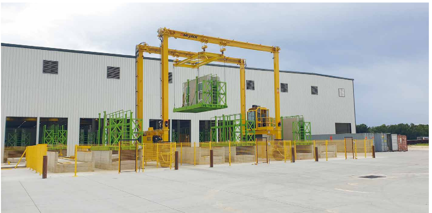
户外区域的搬运工作由一台可移动龙门起重机完成，负责墙体运输架在仓库内外的运送
