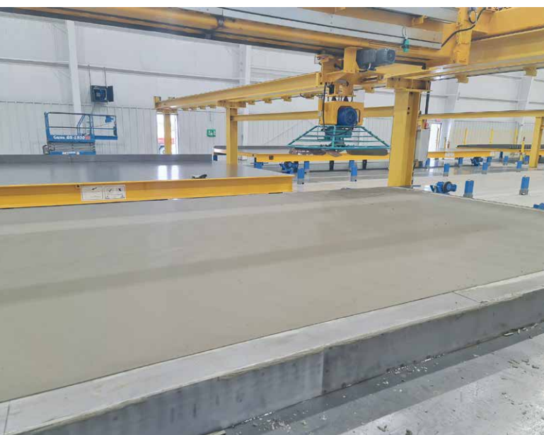
三条托盘循环线可用于对混凝土表面进行平滑处理
