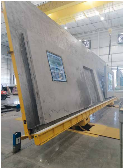
借助自动化运输系统，完工的墙体经由指定的墙体运输轨道运出车间
