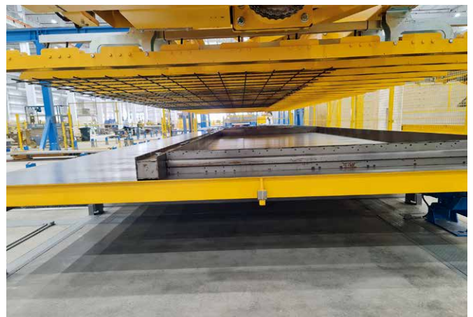
配备了网状焊接设备的全自动钢筋加工系统
