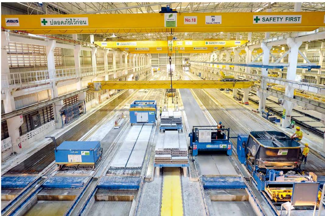
两个工厂配备了生产空心板的新机器
