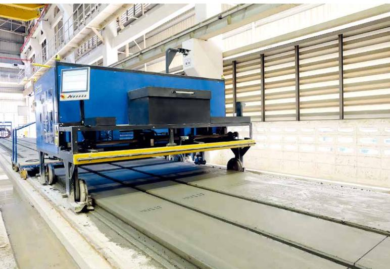
自动绘图仪 SmartJet 正在处理导入在 Ebos HC 软件中的 CAD 数据。这台机器确保能在板坯上进行快速打标，不会出错。测线标记能够同时进行
