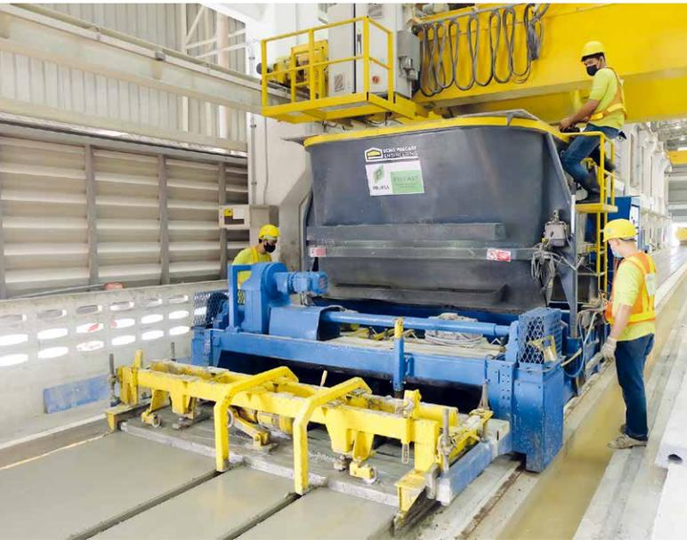
滑动成形机 S-Liner 是一种灵活的机器。可同时生产 1 块 1.2 米宽的板坯和 2 块 0.6 米宽的板坯或 2 块 1.2 米宽的板坯
