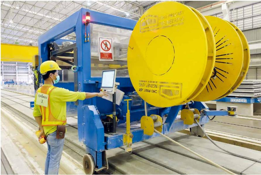
全自动 MAS 多角度锯床预计会被配备安全传感器，以确保环境安全。通过使用 Echo 预制工程公司的专利“测线”技术，配备该机器的目的是为了实现在全自动化作业
