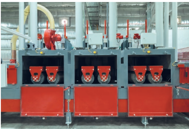
Warstwy wyrobów przejeżdżają łącznie pod sześcioma szczotkami.
