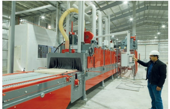
Maszyna do szczotkowania posiada własny system sterowania, z panelem obsługi i wizualizacją.
