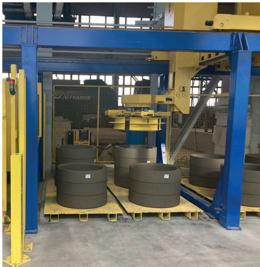
Produzione completamente automatica di anelli di compensazione, movimentazione con l'impilatore automatico Ringmaster.
