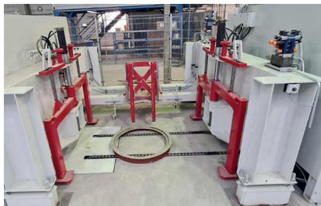
Stazione di impilaggio per manicotti inferiori
