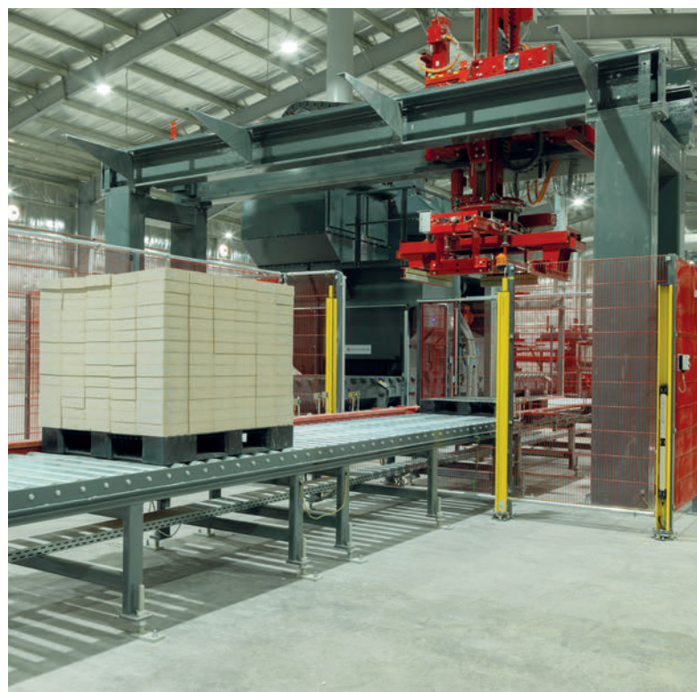
I pacchi di blocchi da trattare vengono trasportati con il trasportatore per carichi pesanti all'impilatore strati LPU.
