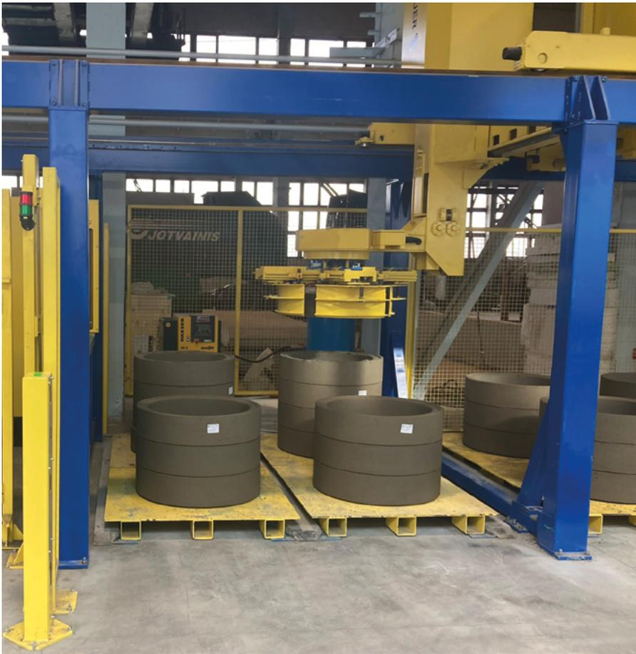
Fabrication entièrement automatisée de rehausses sous cadre, manutention via l'empileur du Ringmaster.
