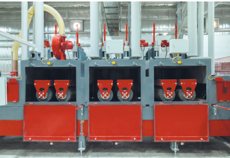
Les couches de pavés ou les dalles de béton passent sous 6 brosses.
