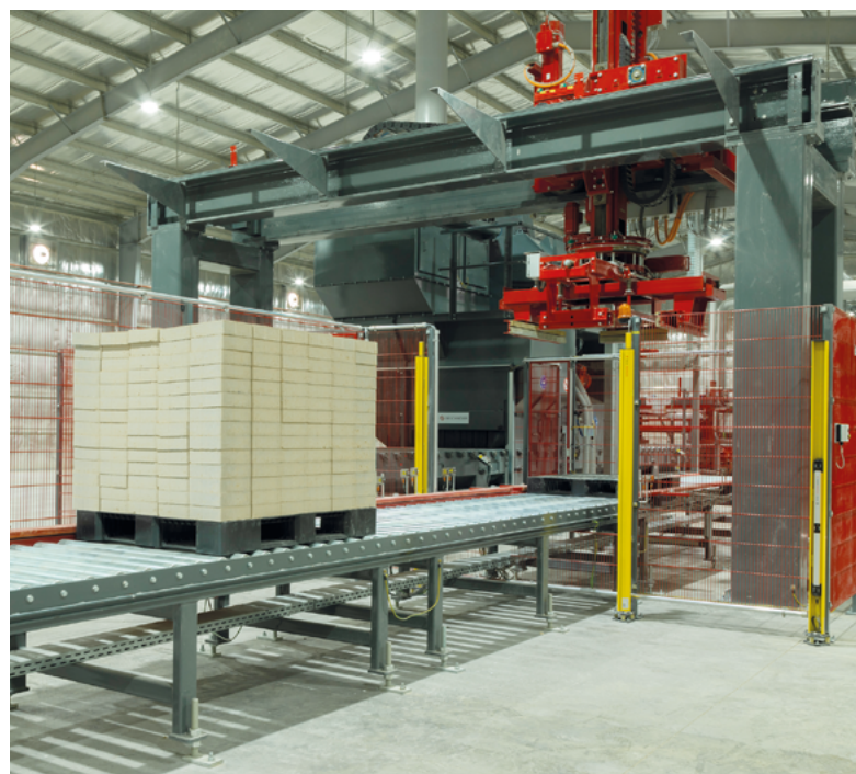
Les paquets de pavés à traiter sont acheminés jusqu'à l'empileur LPU par un convoyeur à charges lourdes.
