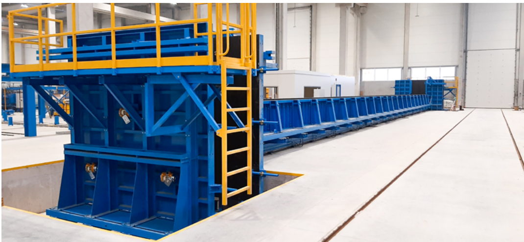
Moules pour poteaux et socles de fondation
