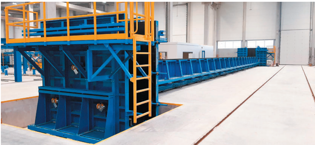
Moldes para pilares y bases de cimentación
