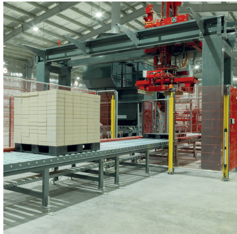
Die zu veredelnden Steinpakete werden auf dem Schwerlastförderer zum Lagenstapler LPU transportiert.
