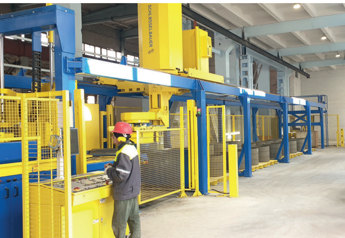
Produktionsanlage Ringmaster von Schlüsselbauer Technology im täglichen Einsatz bei Kauno Gelzbetonis
