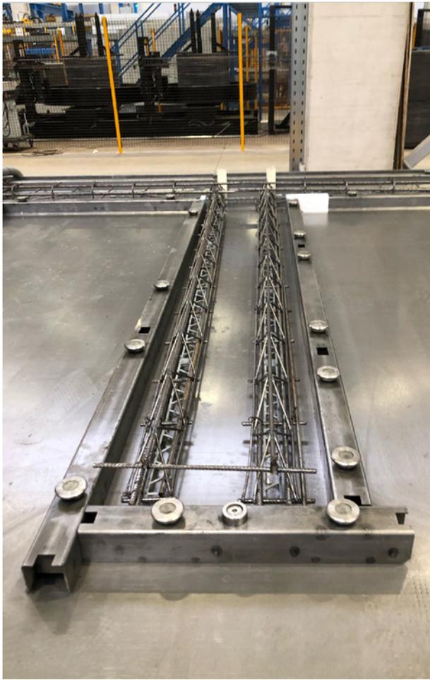
使用 Form Master 板材安装机器人和板材拆卸机器人，即使是再小的切口也可以根据 CAD 数据的精确规格自动实现
