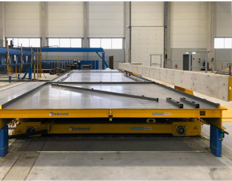
可根据计划将模板准确地放在构件中所需要放置的位置，这可以在很短的时间内自动完成
