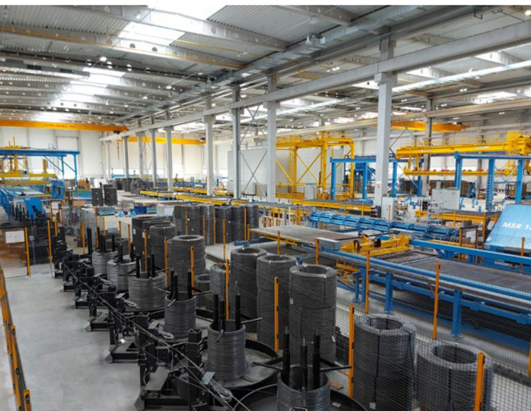
自动化工厂整合了生产钢筋的机器，因此生产混凝土构件所需的一切都可以在工厂里完成
