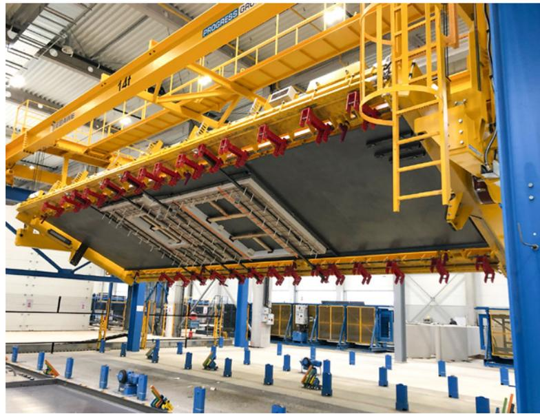
Ebawe Anlagentechnik 的翻转设备是完全自动化的，可以精确到毫米
