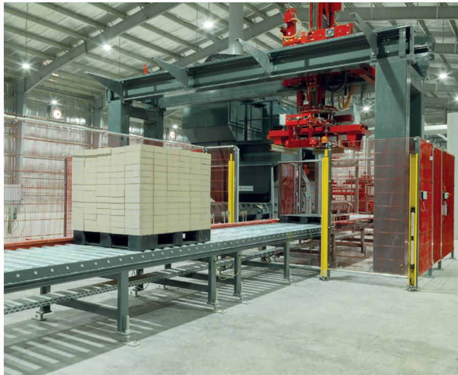
加工好的石料包由重型输送机输送到 LPU 堆垛机
