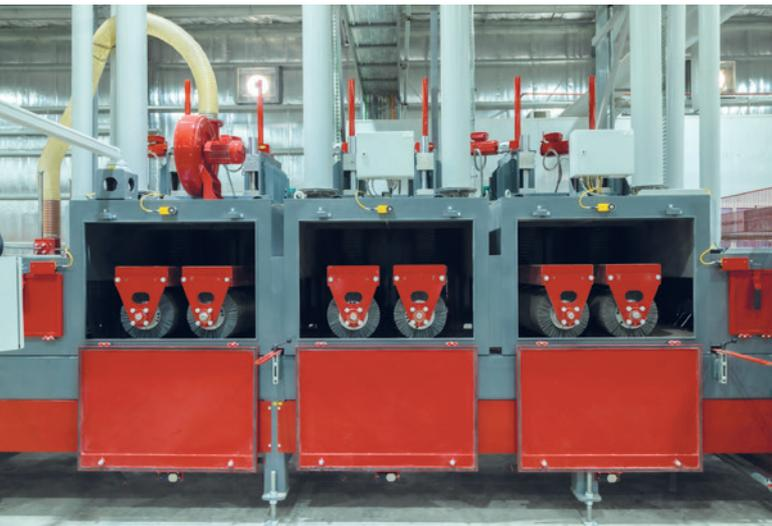
混凝土石层或石板经过 6 个刷子的加工处理
