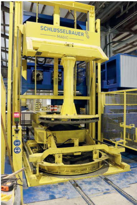
Заполнение системы Magic бетоном. Процессы виброуплотнения и выгрузки готового продукта полностью автоматизированы
