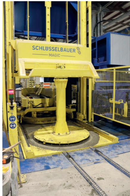
Заполнение системы Magic бетоном. Процессы виброуплотнения и выгрузки готового продукта полностью автоматизированы
