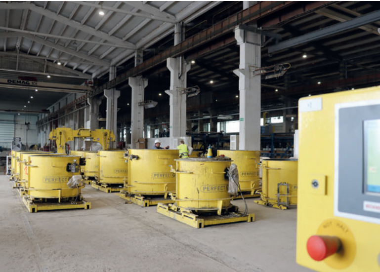
В работе с 2013 года: система Perfect для вибролитьевого производства оснований бетонных колец с днищем. Фото из архива SBT EINFÜGEN
