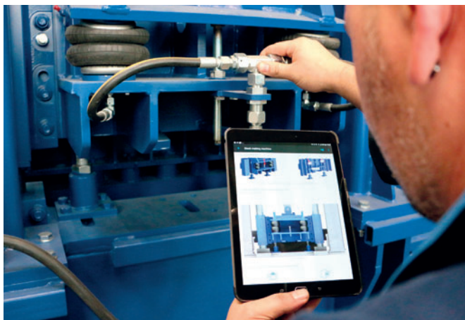
Masa Health Check: проверка подшипников пресс-формы
