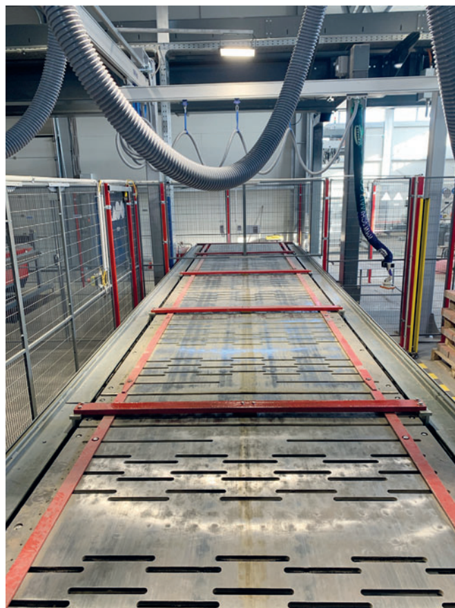
Специальный конвейер линии для нанесения покрытия
