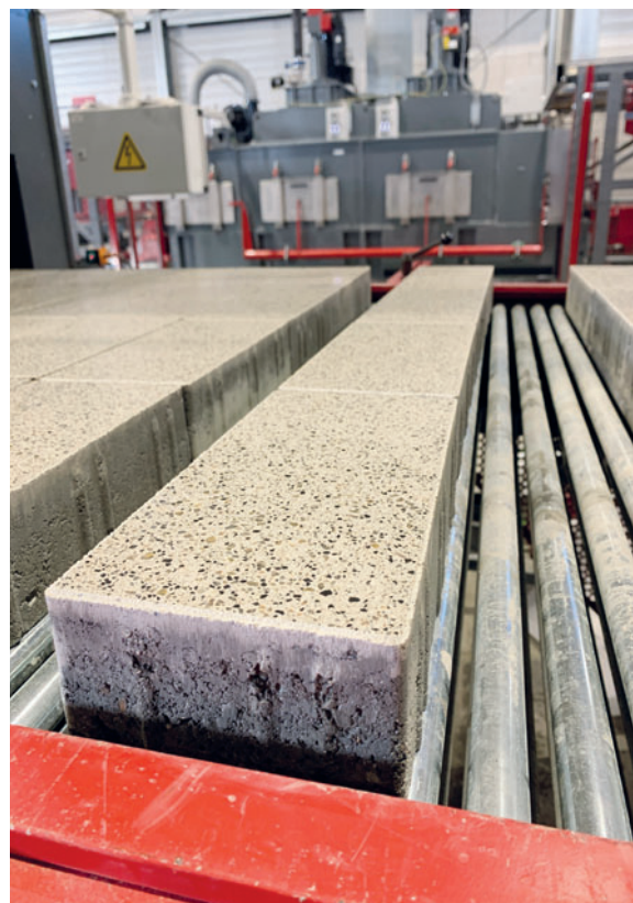
Отшлифованные изделия и калибровочная машина
