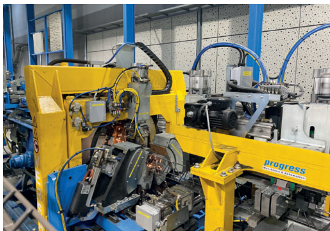
Установки для сварки решетчатых балок VGA для гибкого производства с бухты
