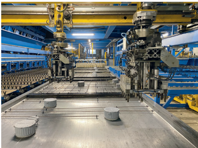
Многоосный робот для размещения арматуры
