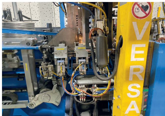
Установки для сварки решетчатых балок VGA для гибкого производства с бухты
