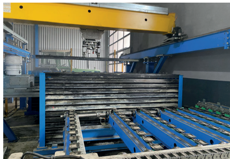
Складской робот на активном складе
