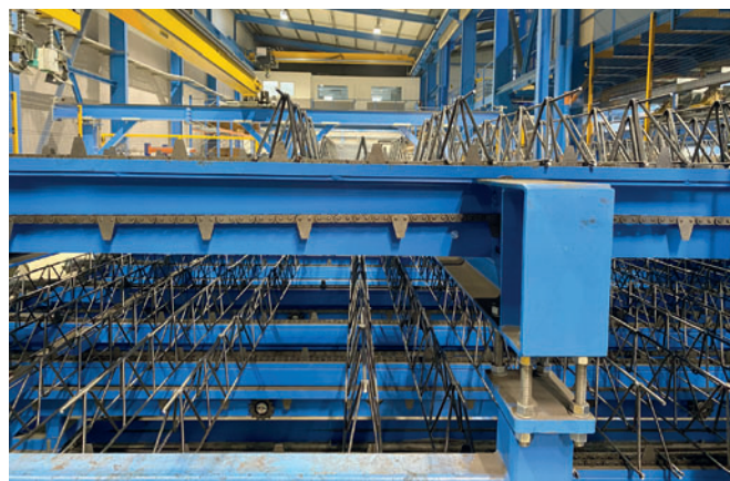
Все изготовленные решетчатые балки помещаются в накопитель роботом-краном, который затем автоматически и по отдельности подает их укладочному роботу
