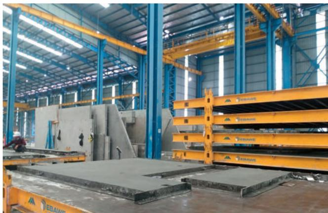
*I solai e le pareti a getto pieno sono già dotati di armatura e pronti per il trasporto e il montaggio in cantiere.*
