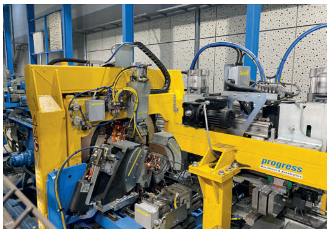
Saldatrice di tralicci VGA Versa per una produzione flessibile dei tralicci dal coil
