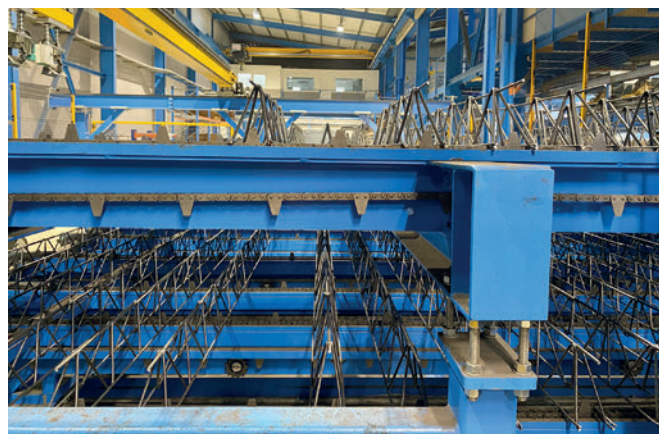
Tutti i tralicci prodotti vengono depositati tramite gru robot sul magazzino di accumulo, che poi li porta automaticamente e separati al robot di posa.
