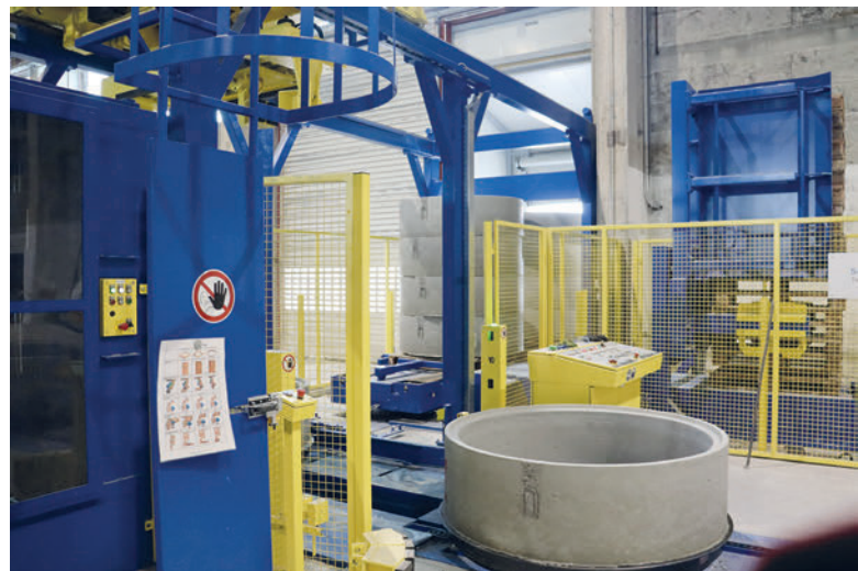
L'altezza massima di impilamento è di 2.000 mm, in questa foto sono rappresentati quattro anelli per pozzetti rispettivamente con un'altezza di 500 mm.
