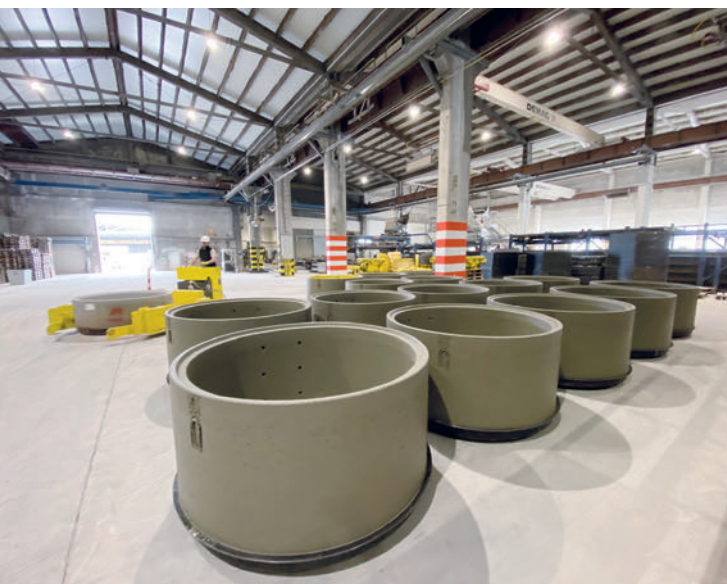
Prodotti appena fabbricati nell'area di indurimento del capannone di produzione
