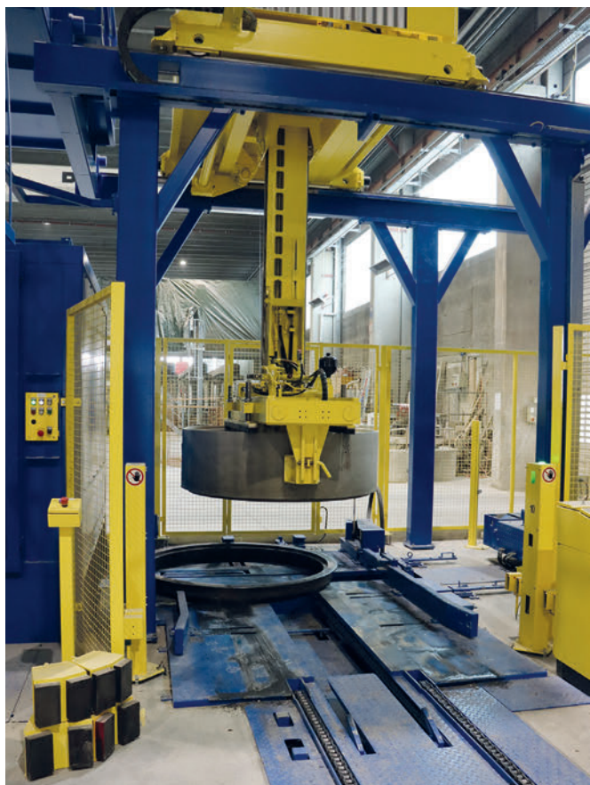
Dopo che il manipolatore ha sollevato l'elemento per pozzetti e l'ha staccato dal fondello, quest'ultimo viene introdotto direttamente nella stazione di pulizia.
