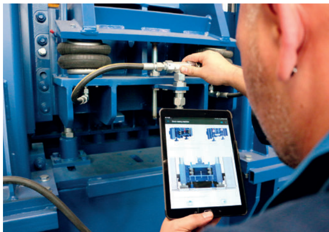
Health Check Masa: ispezione appoggio stampo
