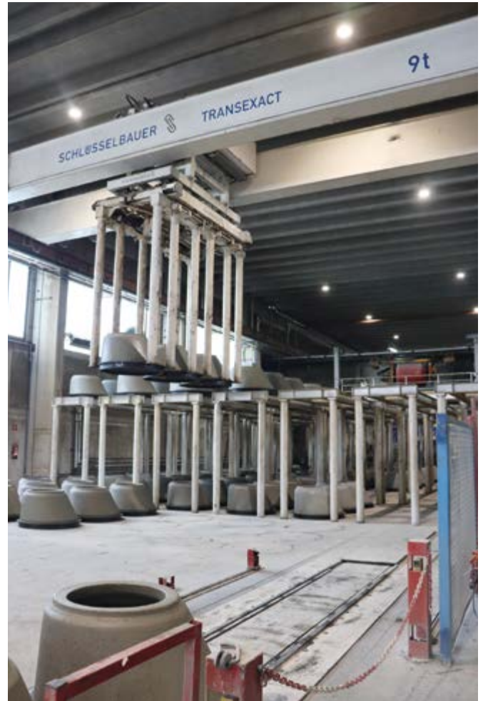
L'installation de production entièrement automatisée Exact pour tuyaux et éléments de regard est en service à Sollenau depuis 1998.
