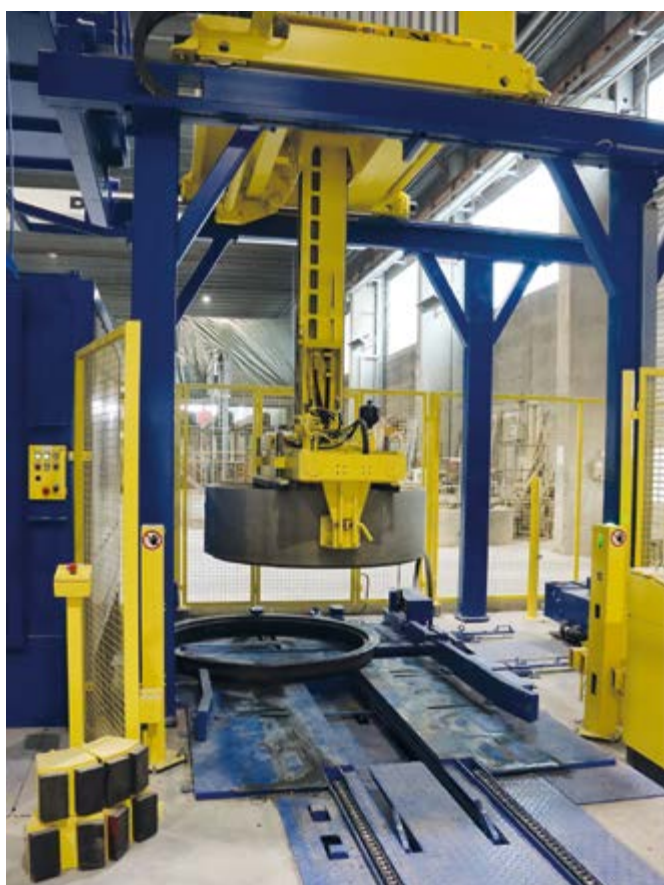
Une fois que la pince a soulevé l'élément de regard, procédant ainsi au débagage de l'embase, celle-ci est directement insérée dans la station de nettoyage.
