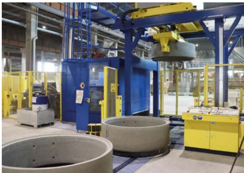
Vue d'ensemble du Palettiseur avec la station de nettoyage adjacente (en bleu) puis la station de graissage des embases
