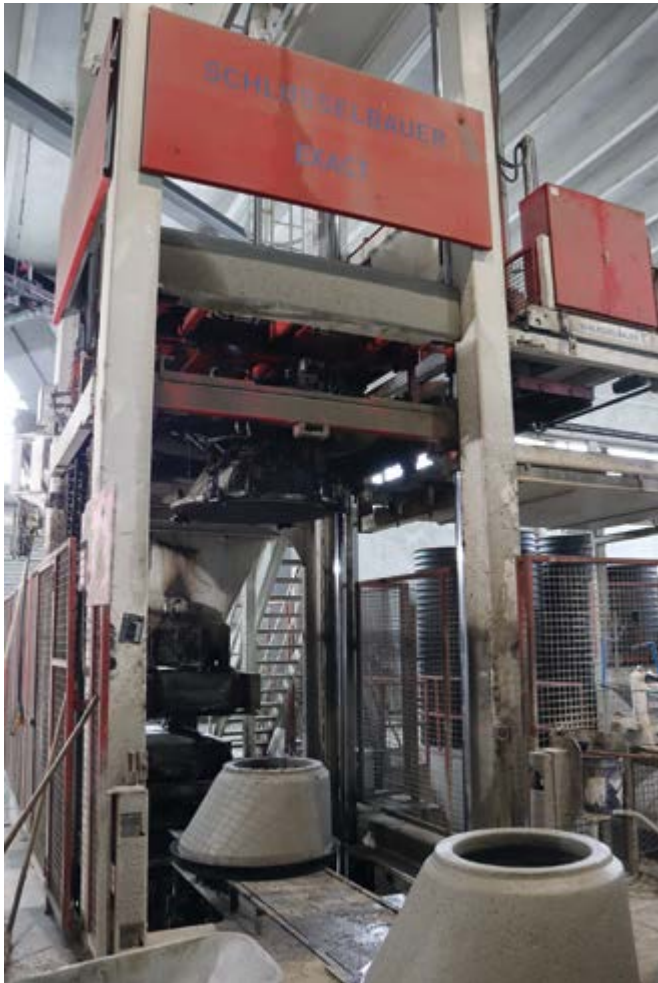
L'installation de production entièrement automatisée Exact pour tuyaux et éléments de regard est en service à Sollenau depuis 1998.
