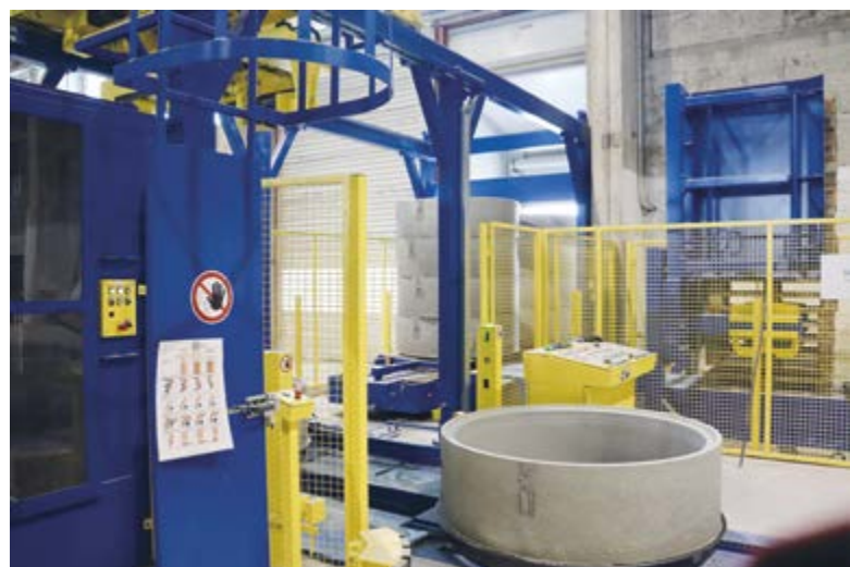
La hauteur de pile maximale est de 2 000 mm : par exemple pour 4 regards d'une hauteur de 500 mm chacun.
