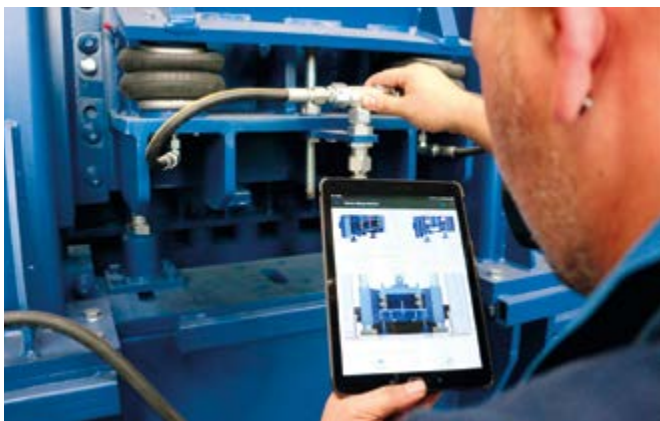
Masa Health Check : inspection de l'appui du moule
