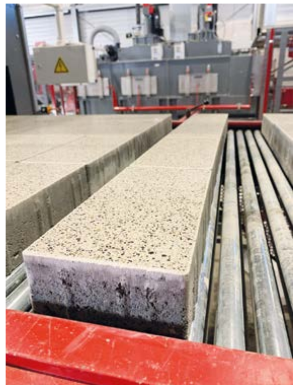
Produits rectifiés et, en face, la machine à calibrer
