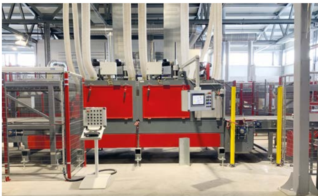
Machine de curling avec panneau de commande sur bras pivotant
