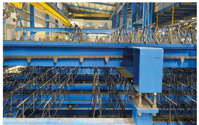
Todas las armaduras de celosía terminadas se depositan con un robot de grúa en un almacén intermedio, que posteriormente las dirige automáticamente y por separado al robot de colocación.
