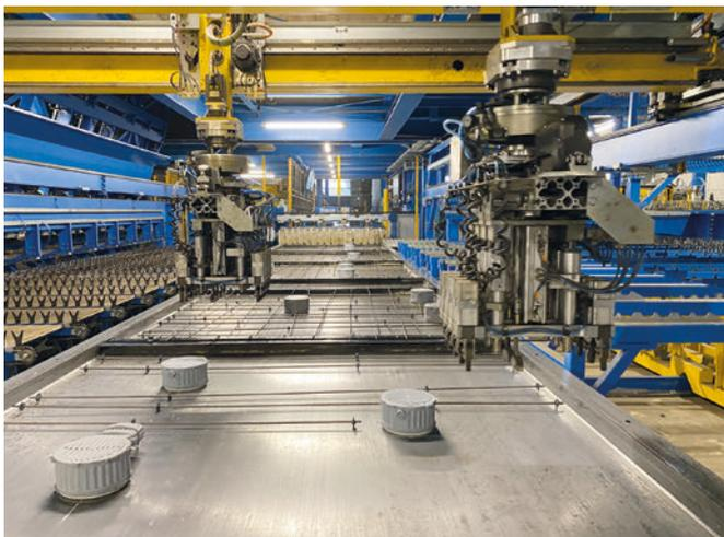
Robot de varios ejes para colocar la armadura
