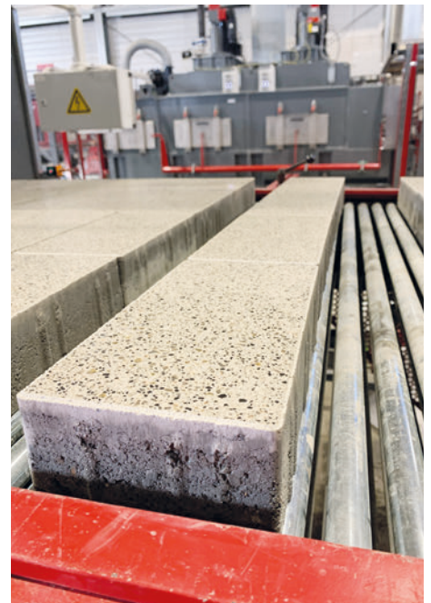
Productos rectificados y enfrente, la máquina de calibración
