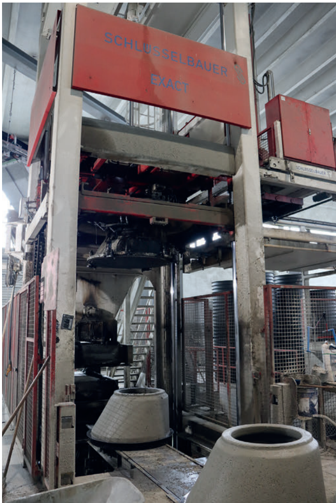
Das modulare, vollautomatische Produktionssystem Exact für Rohre und Schachtbauteile ist seit 1998 in Sollenau in Betrieb.
