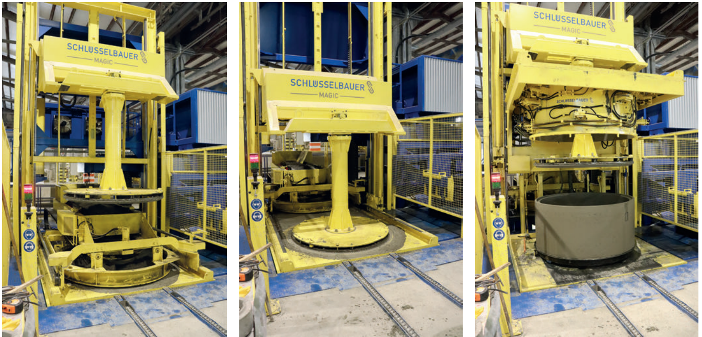
Die Befüllung der Fertigungsanlage Magic mit Beton, der Verdichtungsprozess und der Ausstoß des fertigen Produktes erfolgen vollautomatisch.
