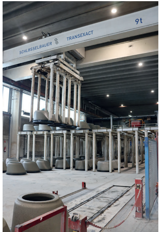
Das modulare, vollautomatische Produktionssystem Exact für Rohre und Schachtbauteile ist seit 1998 in Sollenau in Betrieb.
