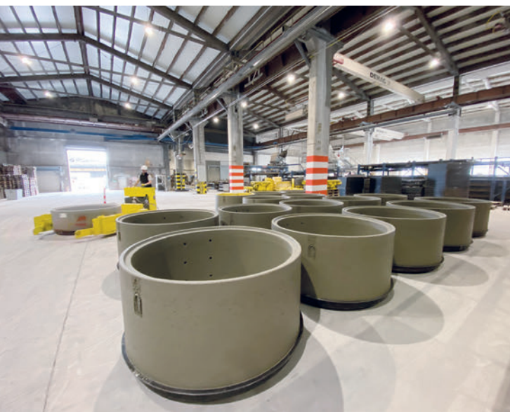
Frische Produkte im Aushärtebereich der Produktionshalle
