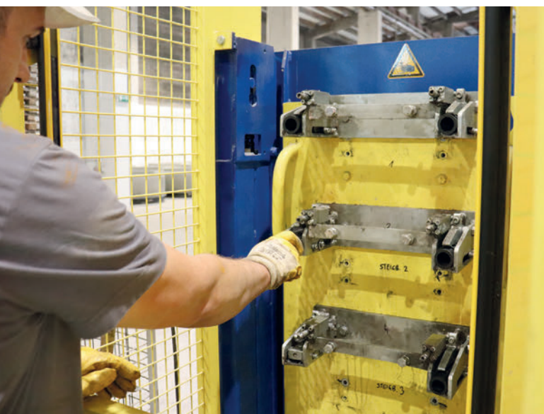
Einlegen von Hülsen für optionale Steigeisen in das Magazin des Stepmasters
