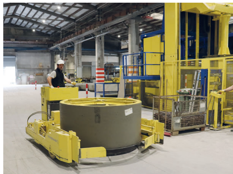
Abfahrwagen für den Transport von frischen und ausgehärteten Produkten
